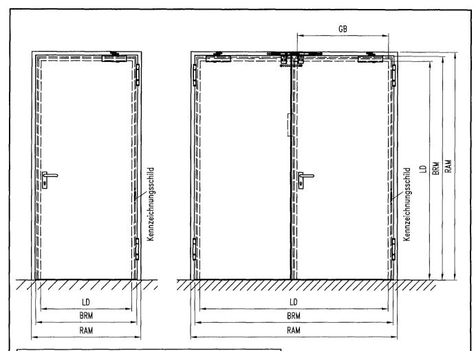
T90-1-RS-FSA und T90-2-RS-FSA immer mit absenkbarer Bodendichtung oder umlaufender Zargendichtung ausführen. Wandanschluss immer mind. auf Öffnungsseite (Bandseite) des FSA versiegeln!
