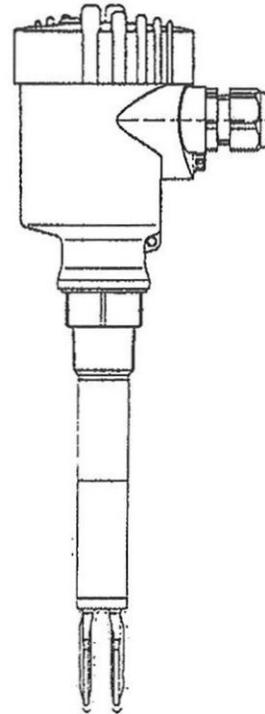
**Schema der Überfüllsicherung**
