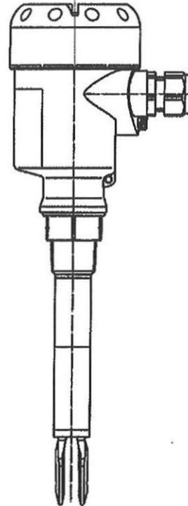
**Schema der Überfüllsicherung**
