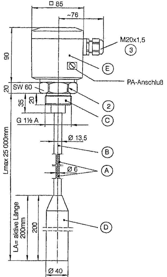
**Schema der Überfüllsicherung**
