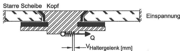
Steifigkeit bei Querkrafteinwirkung  $348 \text{ N/mm} \leq C_Q *$
