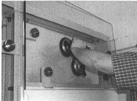
**Bild 6: Glasscheibe einsetzen**
