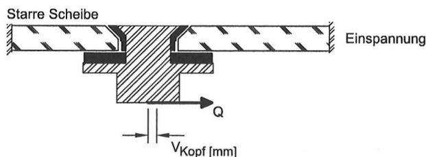
Steifigkeit bei Querkrafteinwirkung  $2.707 \text{ N/mm} \leq C_Q$  \*
