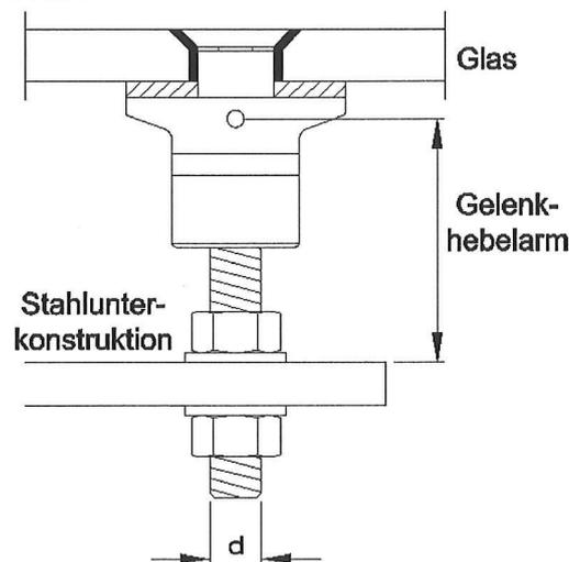
Die maximale Verdrehung des Haltebolzens im eingebauten Zustand darf unter Berücksichtigung der Verdrehung bei der Montage den Wert der Anlage 7 nicht überschreiten.
