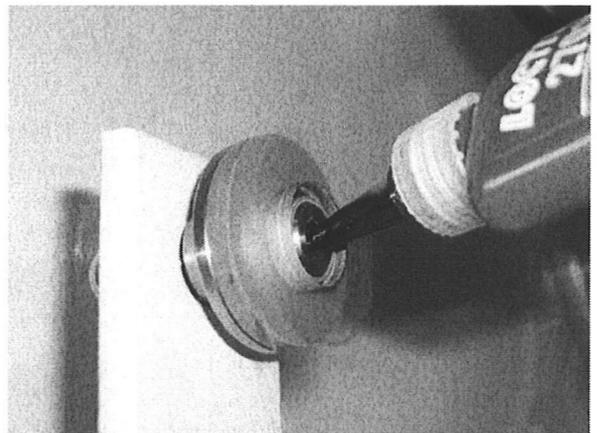
**Bild 4: Schraubensicherung anbringen**
