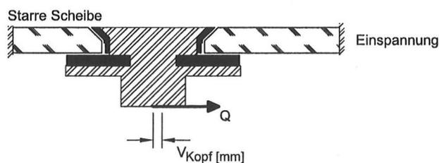
Steifigkeit bei Querkrafteinwirkung  $5.502 \text{ N/mm} \leq C_Q$  \*
