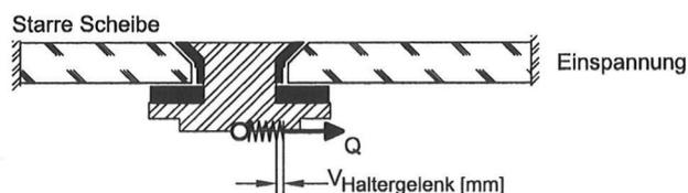
Steifigkeit bei Querkrafteinwirkung  $334 \text{ N/mm} \leq C_Q$  \*
