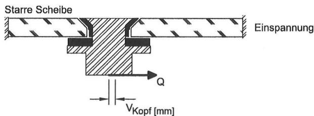
Steifigkeit bei Querkrafteinwirkung  $2.010 \text{ N/mm} \leq C_Q *$
