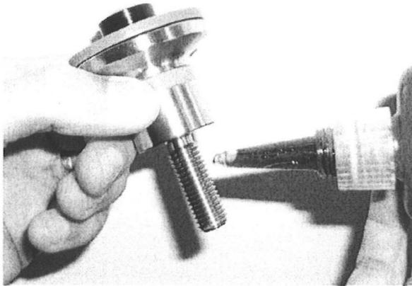
**Bild 1: Schraubensicherung anbringen**
