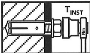
Montagemoment  $T_{inst}$  mit Drehmomentschlüssel aufbringen.
