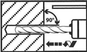
Bohrloch senkrecht zur Oberfläche des Verankerungsgrunds erstellen.
