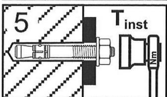
Montagemoment  $T_{inst}$  mit Drehmomentschlüssel aufbringen.
