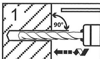
Bohrloch senkrecht zur Oberfläche des Verankerungsgrunds erstellen.
