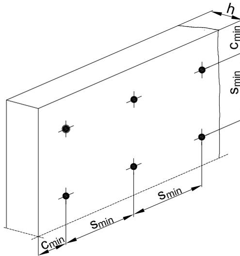
**EJOT SDM-T<sub>plus</sub> , EJOT SDF-K<sub>plus</sub> und SDF-S<sub>plus</sub>**
