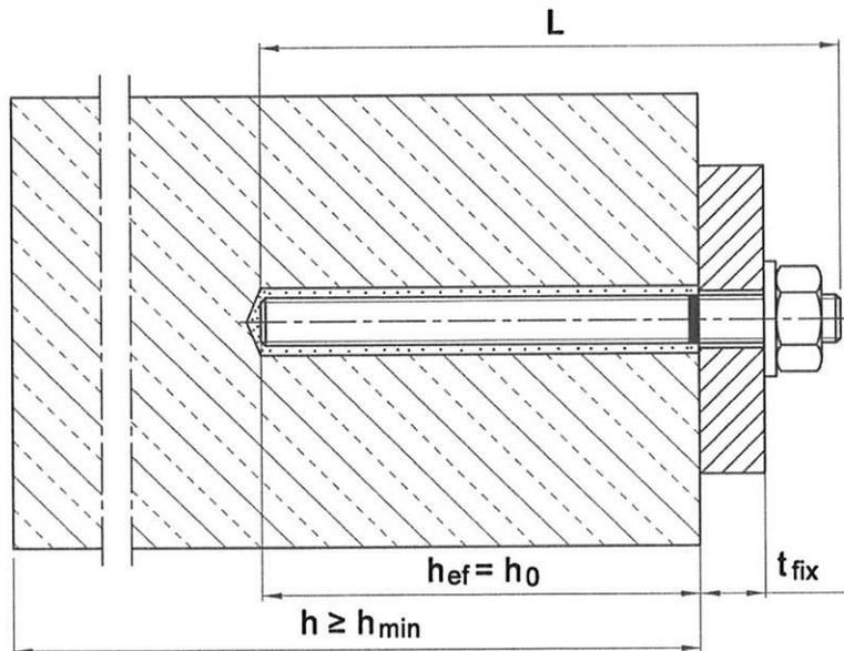
Nutzungskategorie: Ungerissener Beton, Montage im trockenen oder feuchten Beton, oder im wassergefüllten Bohrloch
