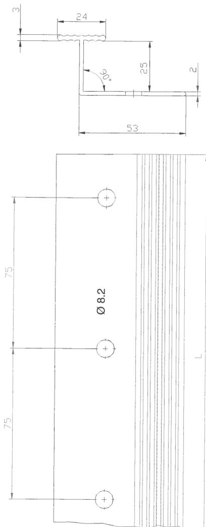
Vertikales Halteprofil - "Sto-Verbindungsleiste PVC" (Maße in mm)
