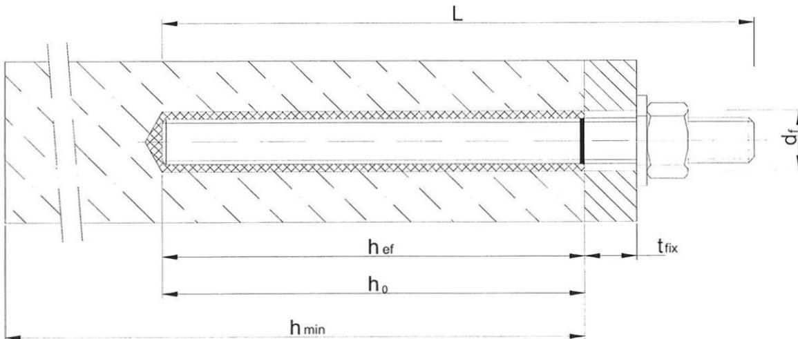
Nutzungskategorie: - Einbau in trockenem oder feuchtem Beton, jedoch nicht in wassergefüllten Bohrlöchern
