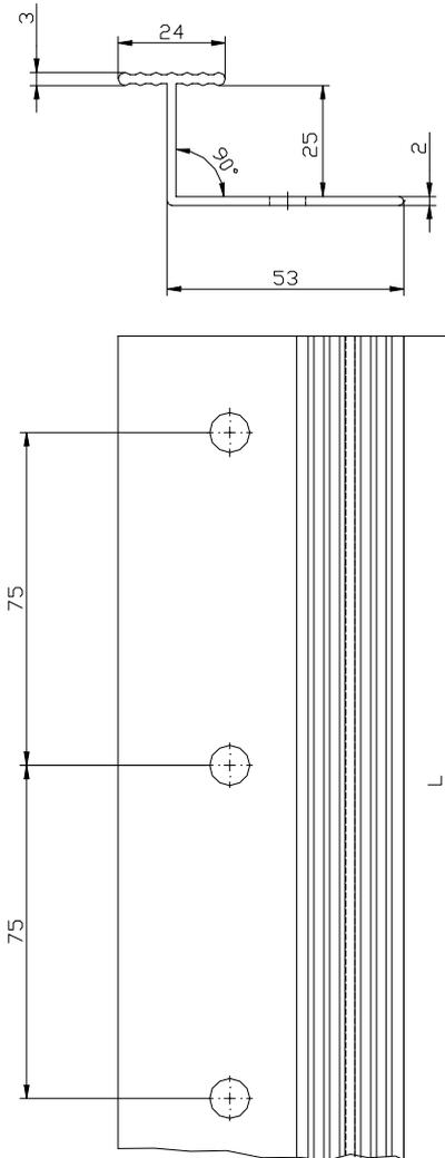
**Vertikales Verbindungsprofil "Arcutherm Verbindungsschiene"** (Dimension in Millimetern)
