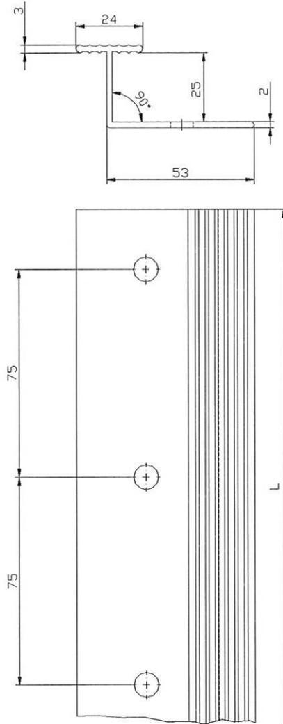
**Vertikales Verbindungsprofil "PVC Verbindungsleiste" (Maße in mm)**
