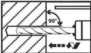
Bohrloch senkrecht zur Oberfläche des Verankerungsgrunds erstellen.
