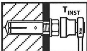
Montagemoment  $T_{inst}$  mit Drehmomentschlüssel aufbringen.
