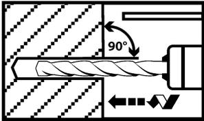
Bohrloch senkrecht zur Oberfläche des Verankerungsgrunds erstellen.
