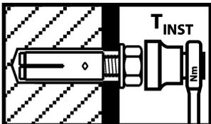
Montagemoment  $T_{inst}$  mit Drehmomentschlüssel aufbringen.
