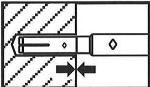
Der Anschlag des Spreizwerkzeugs muss auf dem Ankerrand aufsetzen.
