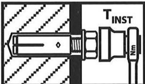
Montagemoment  $T_{inst}$  mit Drehmomentschlüssel aufbringen.
