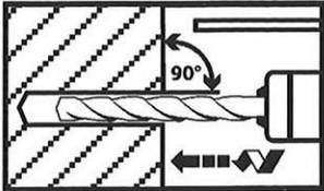
Bohrloch senkrecht zur Oberfläche des Verankerungsgrunds erstellen.
