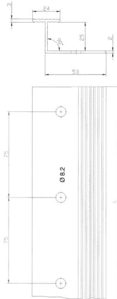
**Vertikales Verbindungsprofil "Sto-Verbindungsleiste PVC" (Maße in mm)**
