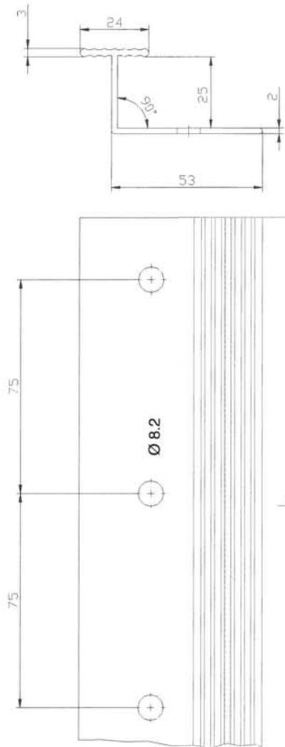
**Vertikales Verbindungsprofil "Sto-Verbindungsleiste PVC" (Maße in mm)**
