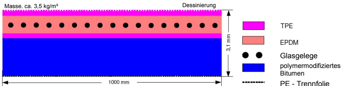
Bitumen – verträgliche, Heißluft verschweißbare EPDM-Synthesekautschukabdichtungsbahn
