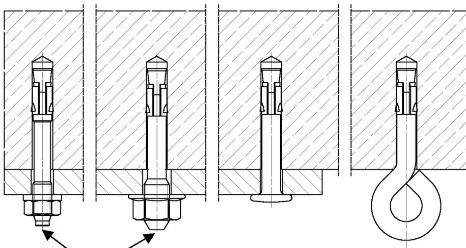
Markierung nur für galvanisch verzinkte Ausführung (gvz) mit einer Verankerungstiefe von  $h_{ef} = 25 \text{ mm}$
