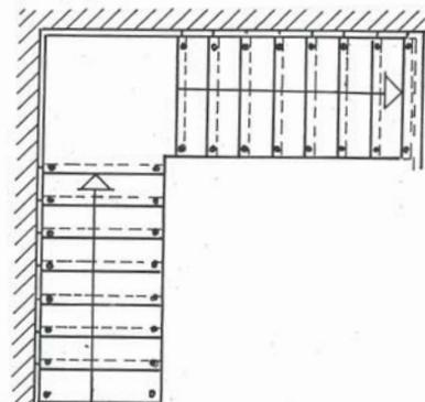
Lauflinie beispielhaft dargestellt, Lage innerhalb des Gehbereiches freiwählbar, Gehbereich beträgt 20 % der nutzbaren Treppenlaufbreite im Mittelbereich der Treppe
