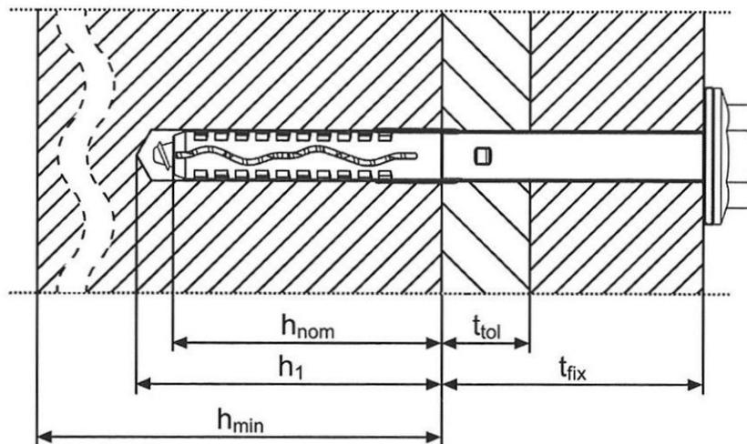
Anwendung in Loch- oder Hohlsteinmauerwerk
