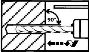
Bohrloch senkrecht zur Oberfläche des Verankerungsgrunds erstellen.
