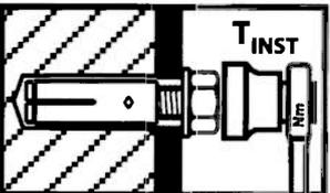
Montagemoment  $T_{inst}$  mit Drehmomentschlüssel aufbringen.
