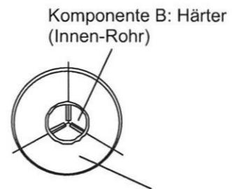
Komponente A: Mörtel (Außen-Rohr)
