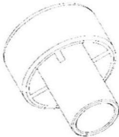
**Verfüllstutzen für Überkopf- oder Horizontalmontage**
