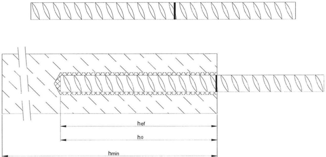
Friulsider Injektionssystem KEM-UP + Vinylester für Beton
