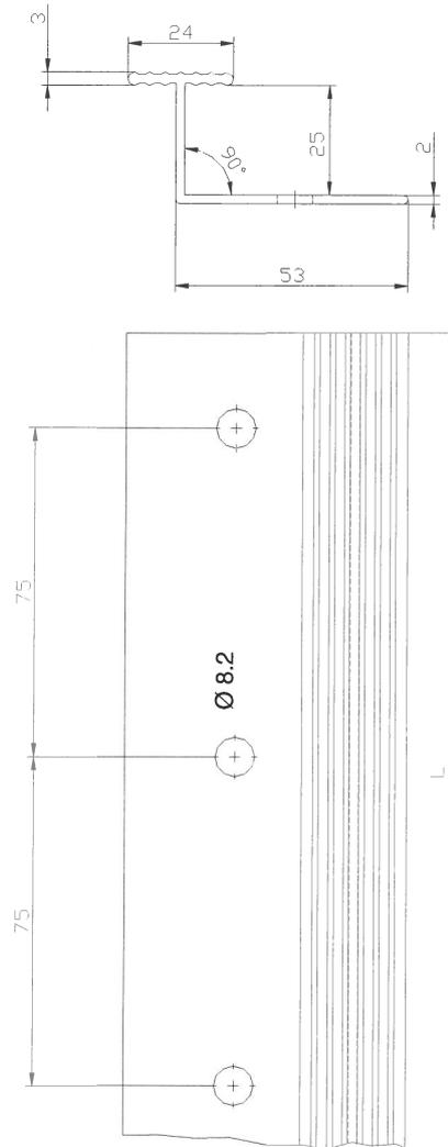
Vertikales Verbindungsprofil "Sto-Verbindungsleiste PVC" (Maße in Millimeter)
