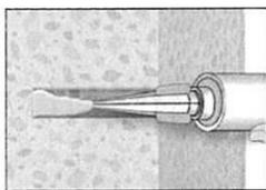
**6.** Gereinigtes Bohrloch vom Bohrlochgrund her ca. zu 2/3 mit Verbundmörtel befüllen. Langsames Zurückziehen des Statkmischers aus dem Bohrloch verhindert die Bildung von Lufteinschlüssen. Für Setztiefen größer 190 mm passende Mischerverlängerung verwenden. Für die Horizontal- oder Überkopfmontage von Ankern > Ø 20 mm sind Verfüllstutzen gemäß Anhang 8 zu verwenden. Die temperaturrelevanten Verarbeitungszeiten (Tabelle 4) sind zu beachten.
