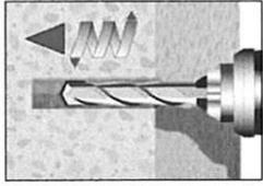
1. Bohrloch drehschlagend mit vorgeschriebenem Bohrerdurchmesser (Tabelle 2 oder Tabelle 3) und gewählter Bohrlochtiefe erstellen.
