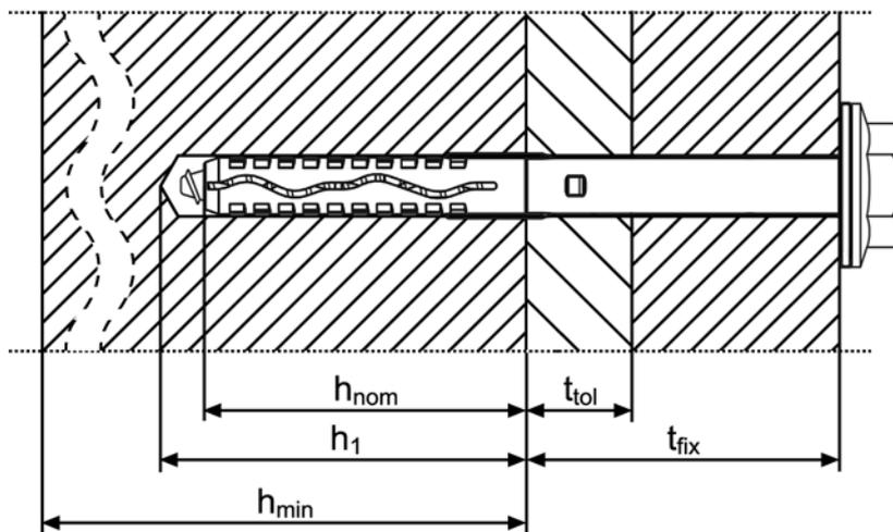
Anwendung in Loch- oder Hohlsteinmauerwerk
