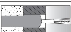
Bei Durchsteckmontage ist die Bohrung im Anbauteil ebenfalls mit Mörtel zu verfüllen. |
