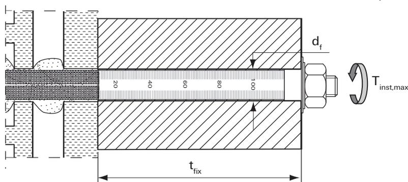
**Ankerstangen ohne Injektions-Ankerhülse FIS HK;
