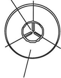
Komponente A: Mörtel (Außen-Rohr)
