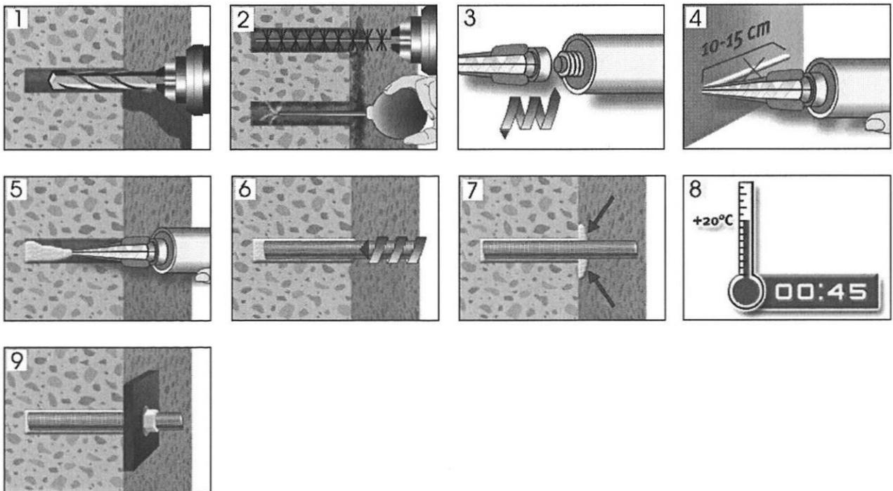
Interfixings Injektionssystem FIX
