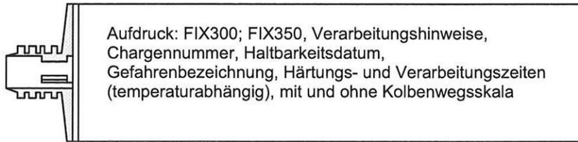
Aufdruck: FIX300; FIX350, Verarbeitungshinweise, Chargennummer, Haltbarkeitsdatum, Gefahrenbezeichnung, Härtings- und Verarbeitungszeiten (temperaturabhängig), mit und ohne Kolbenwegsskala
