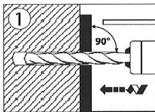
Bohrloch senkrecht zur Oberfläche des Verankerungsgrunds erstellen.
