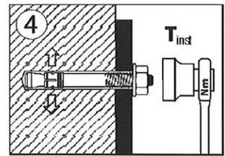
Montagemoment  $T_{inst}$  mit Drehmomentschlüssel aufbringen.
