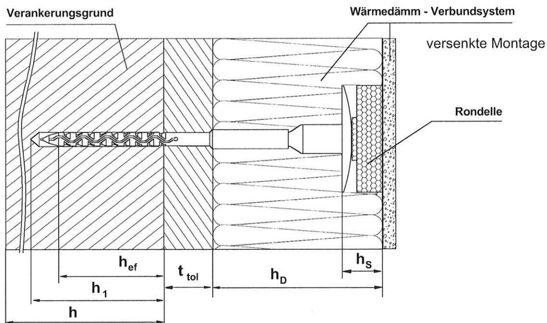
Anwendungsbereich: Verankerung zur Befestigung von Wärmedämm-Verbundsystemen in verschiedenen Mauerwerksarten
