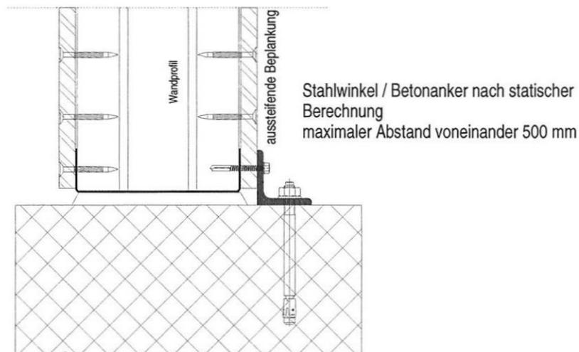
Verbindungsmittel Beplankung, Verschraubung Profile Cocoon, Dämmung, Dampfbremse etc. zur Vereinfachung nicht dargestellt
