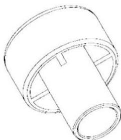
**Verfüllstutzen für Überkopf- oder Horizontalmontage**
