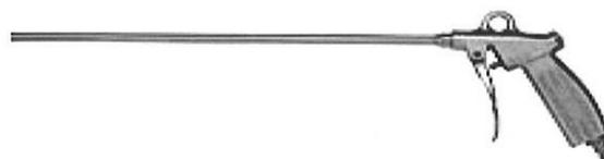
**Empfohlene Druckluftpistole (min 6 bar)**
