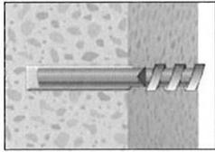
**7.** Befestigungselement mit leichten Drehbewegungen bis zur festgelegten Setztiefe einführen.
