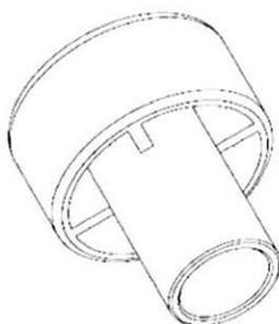
**Verfüllstutzen für Überkopf- oder Horizontalmontage**
