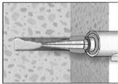
6. Gereinigtes Bohrloch vom Bohrlochgrund her ca. zu 2/3 mit Verbundmörtel befüllen. Langsames Zurückziehen des Statikmischers aus dem Bohrloch verhindert die Bildung von Lufteinschlüssen. Für Setztiefen größer 190 mm passende Mischerverlängerung verwenden. Für die Horizontal- oder Überkopfmontage von Ankern  $> \varnothing 20$  mm sind Verfüllstutzen gemäß Anhang 8 zu verwenden. Die temperaturrelevanten Verarbeitungszeiten (Tabelle 4) sind zu beachten.
