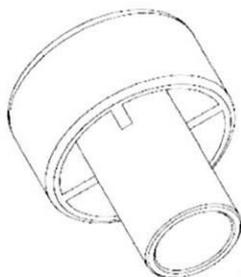
**Verfüllstutzen für Überkopf- oder Horizontalmontage**
