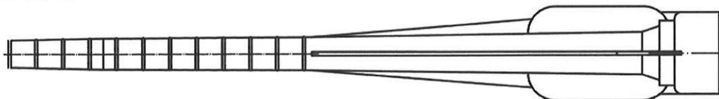
Nutzungskategorie: - Einbau in trockenem, feuchtem Beton (alle Größen) oder wassergefülltem Bohrloch (nur M8 bis M16 und BSt Ø8 bis Ø16)
