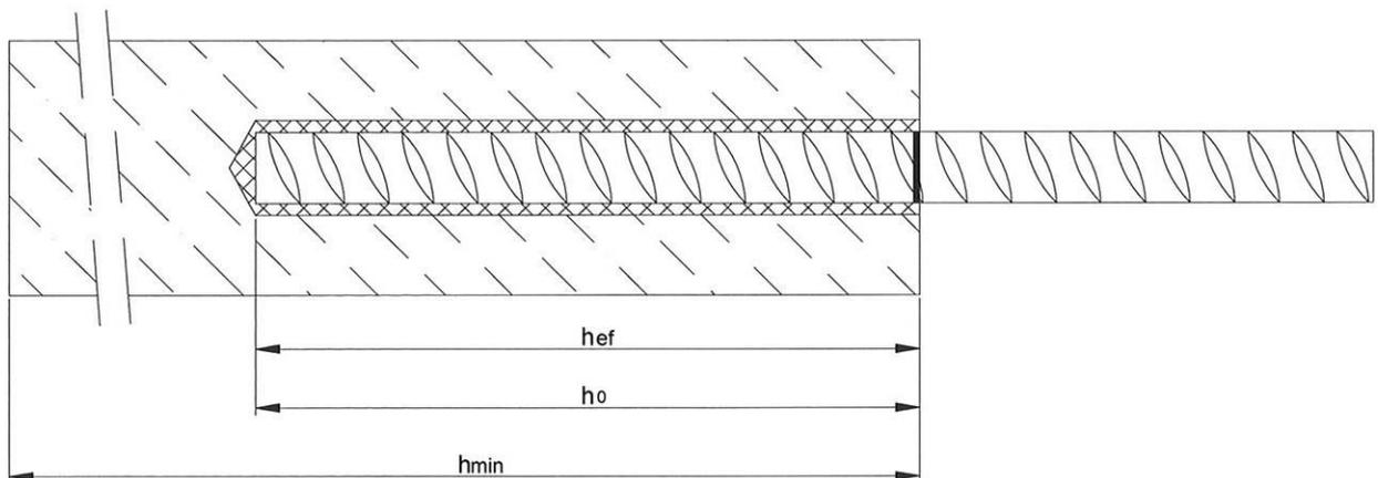
YOLDAS Injektionssystem Memo Chem für Beton
