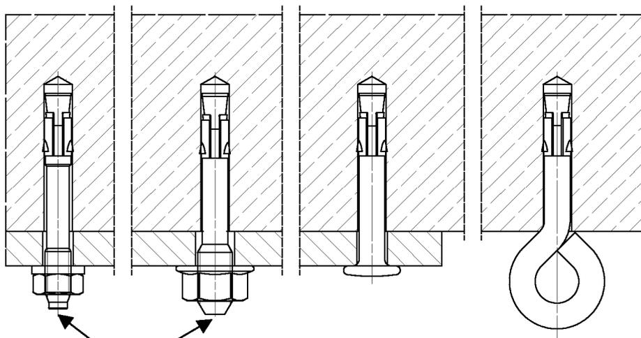
Markierung nur für galvanisch verzinkte Ausführung (gvz) mit einer Verankerungstiefe von  $h_{\text{ef}} = 25 \text{ mm}$
