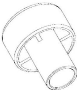
**Verfüllstutzen für Überkopf- oder Horizontalmontage**
