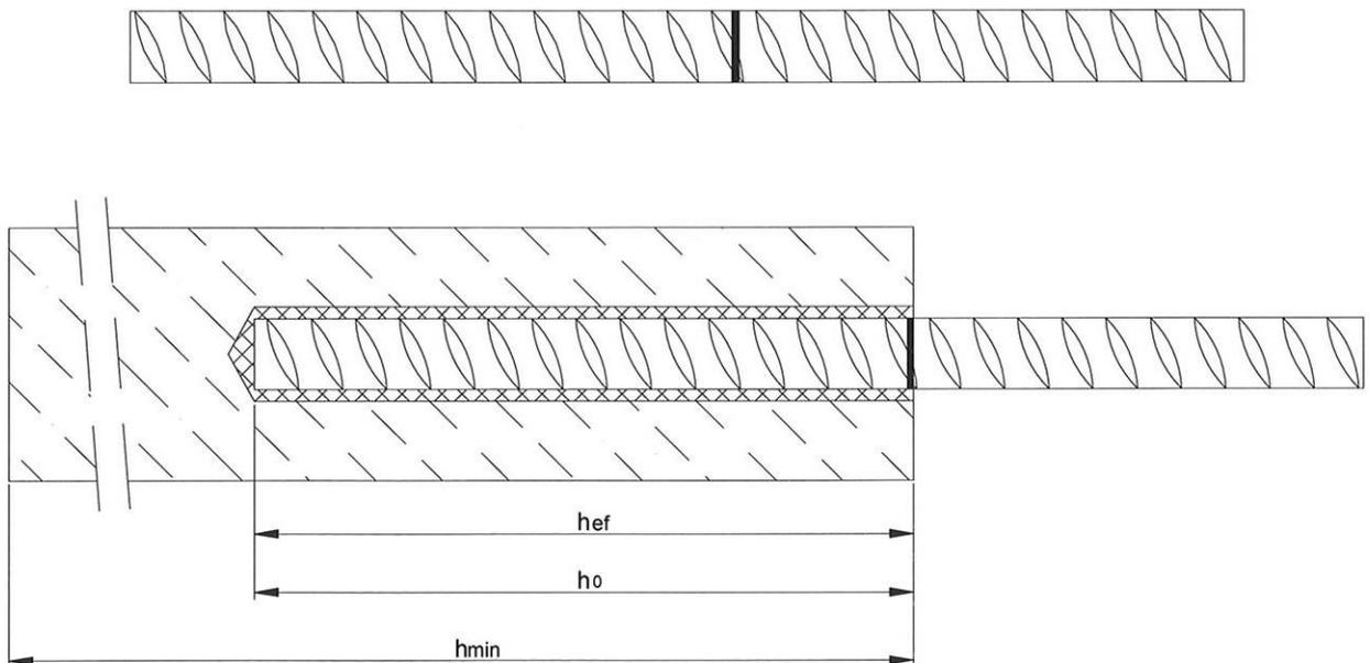
TP Injektionssystem E SD für Beton
