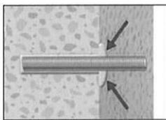
8. Nach Installation des Ankers sollte der Ringspalt komplett mit Mörtel ausgefüllt sein. Tritt keine Masse nach Erreichen der Setztiefe heraus, ist diese Voraussetzung nicht erfüllt und die Anwendung muss vor Beendigung der Verarbeitungszeit wiederholt werden. Bei Überkopfmontage ist die Ankerstange zu fixieren (z.B. Holzkeile).
