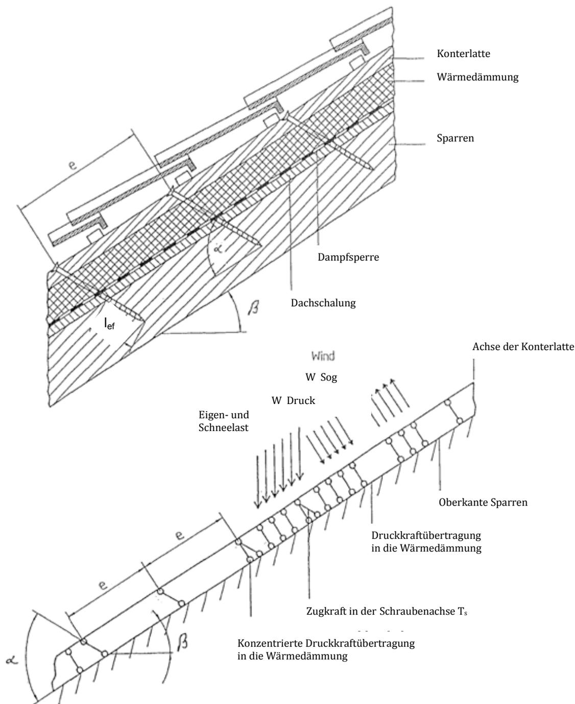
Abbildung 2.1: Befestigung von Aufdach-Dämmsystemen auf Sparren- Statisches Modell für parallel angeordnete Schrauben
