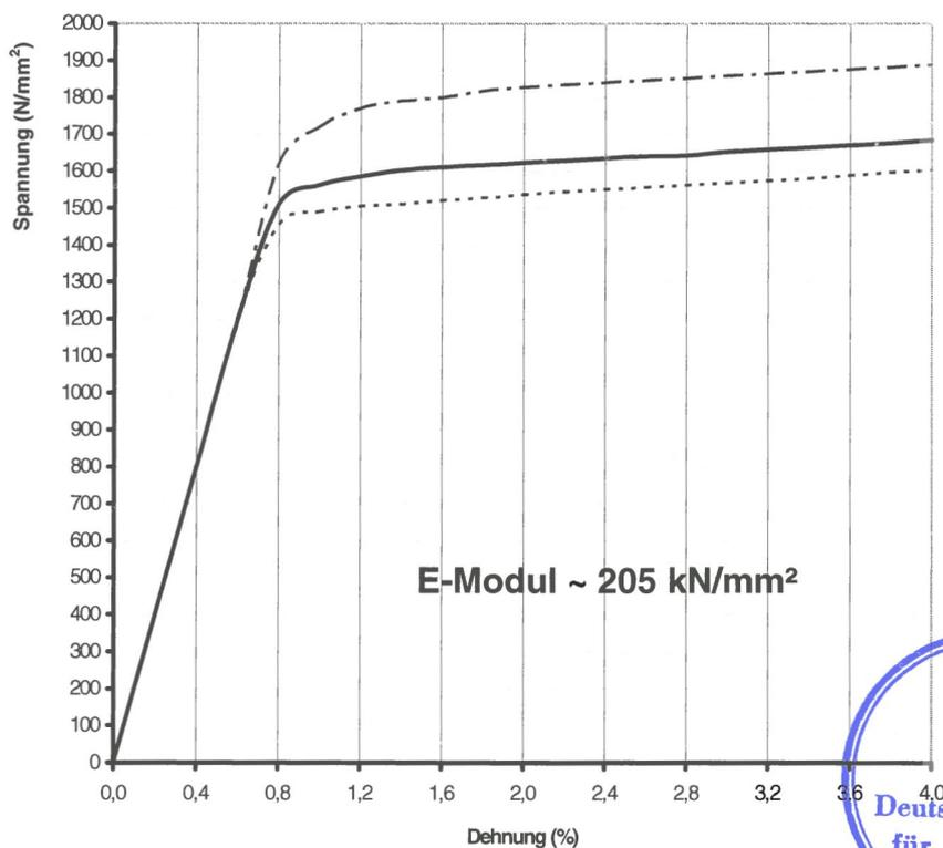
Die gestrichelten Linien markieren etwa den Bereich, innerhalb dessen die tatsächlichen Spannungs-Dehnungslinien auftreten können.
