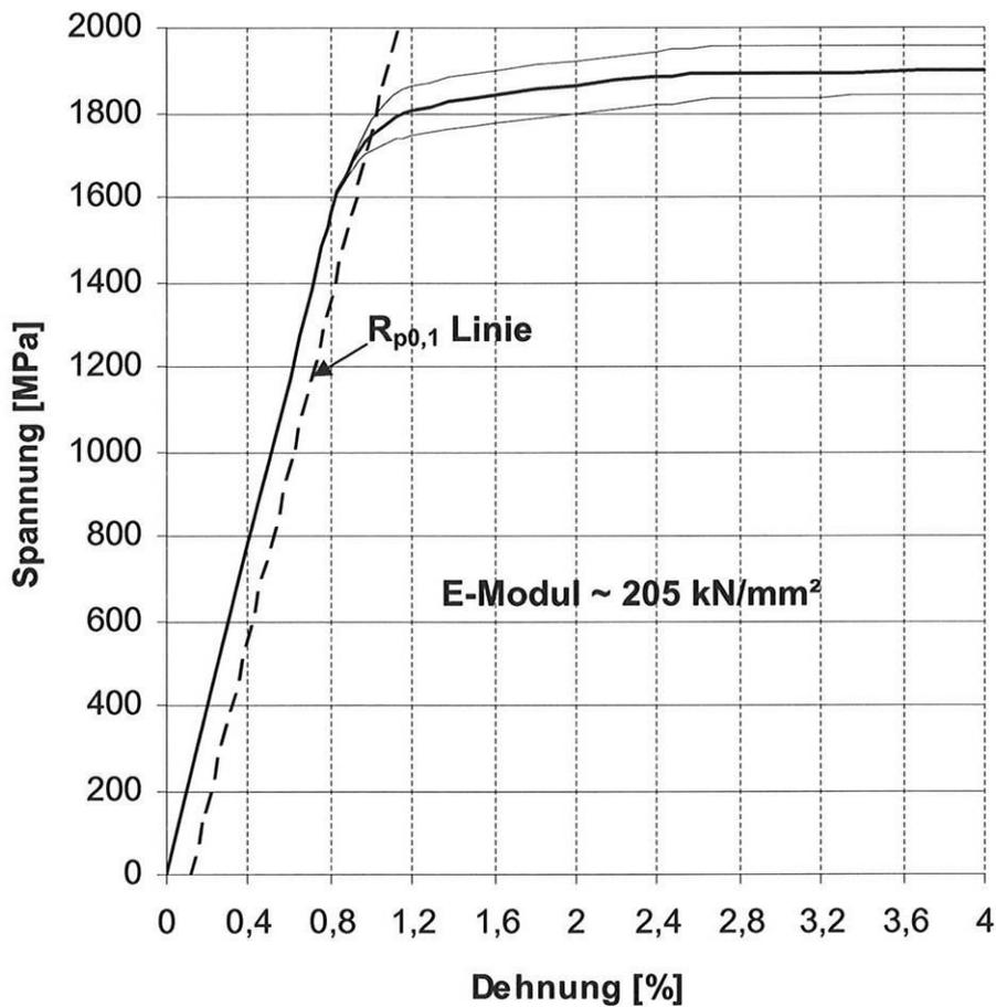
Die gestrichelten Linien markieren den Bereich, innerhalb dessen die tatsächlichen Spannungs – Dehnungslinien auftreten können.
