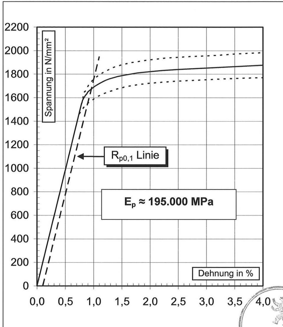
Die gestrichelten Linien markieren den Bereich, innerhalb dessen die tatsächlichen Spannungs - Dehnungslinien auftreten können.
