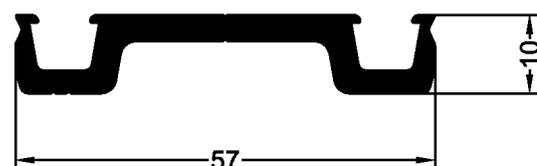
Klemmverbindung für das Fassadensystem Lara GF
