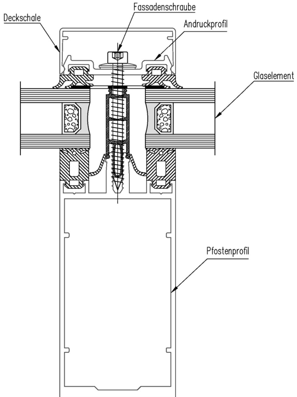
**Klemmverbindung für das Fassadensystem AT 500F**
