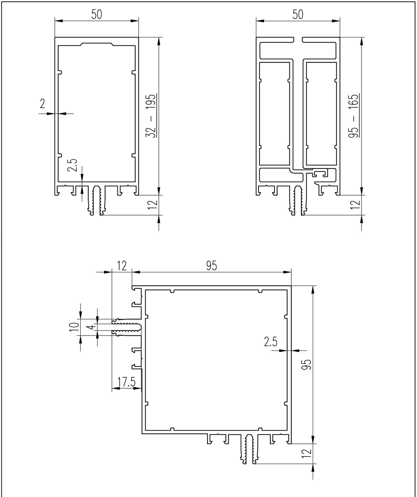
**Klemmverbindung für das Fassadensystem AT 500F**
