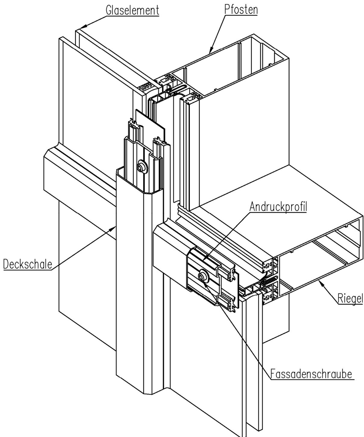
**Klemmverbindung für das Fassadensystem AT 500F**
