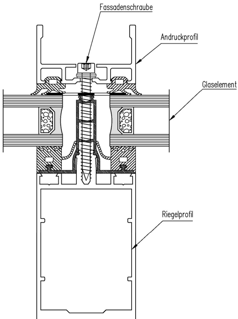
**Klemmverbindung für das Fassadensystem AT 500F**
