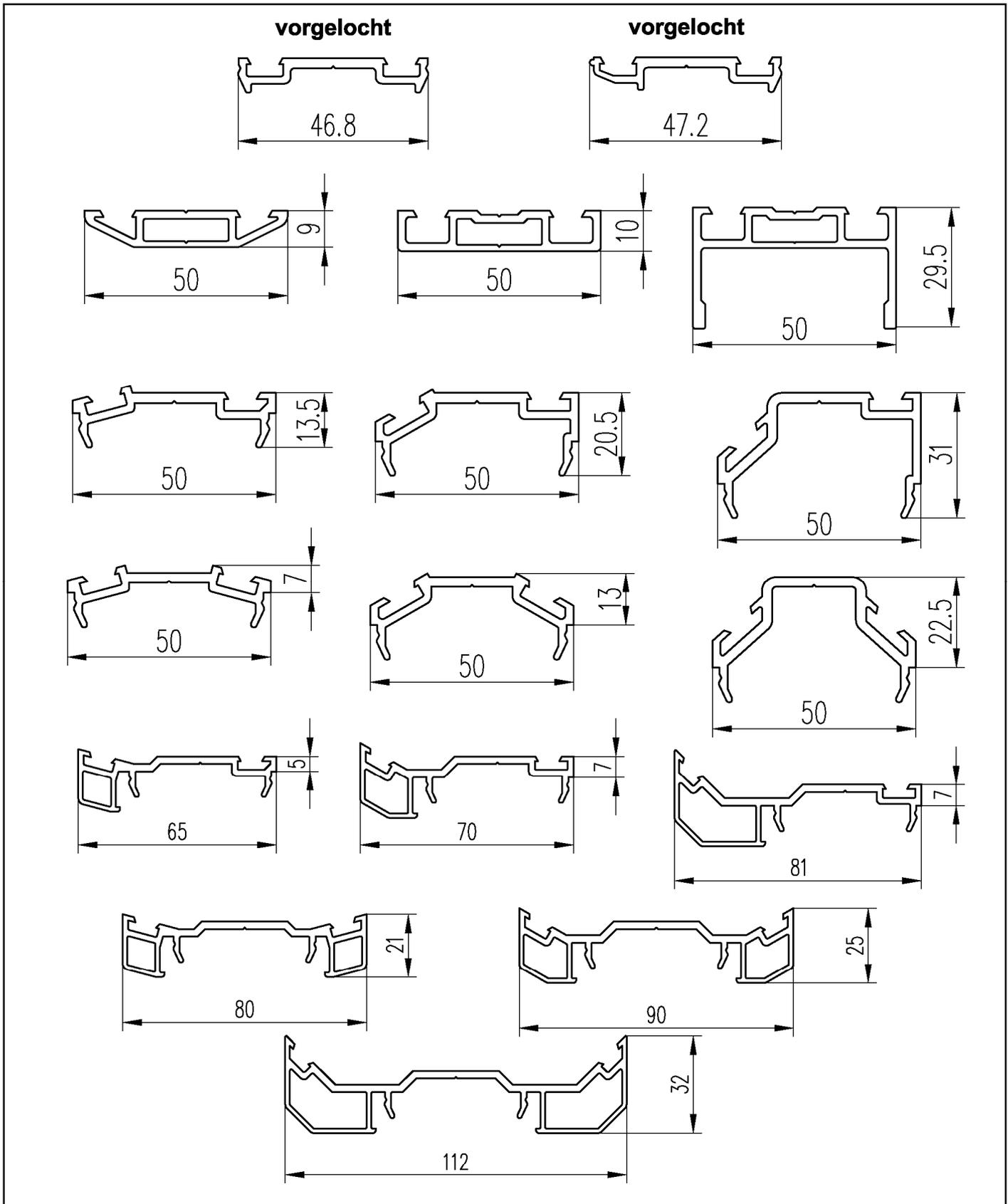
**Klemmverbindung für das Fassadensystem AT 500F**
