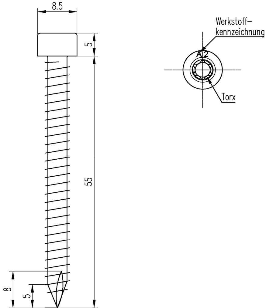
**Klemmverbindung für das Fassadensystem AT 500F**
