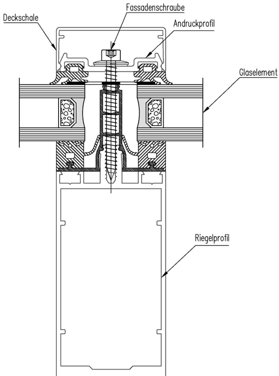
**Klemmverbindung für das Fassadensystem AT 500F**
