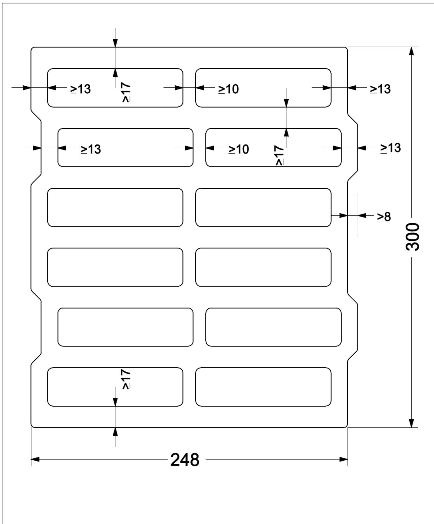
Mauerwerk aus POROTON Planhochlochziegeln mit integrierter Wärmedämmung
