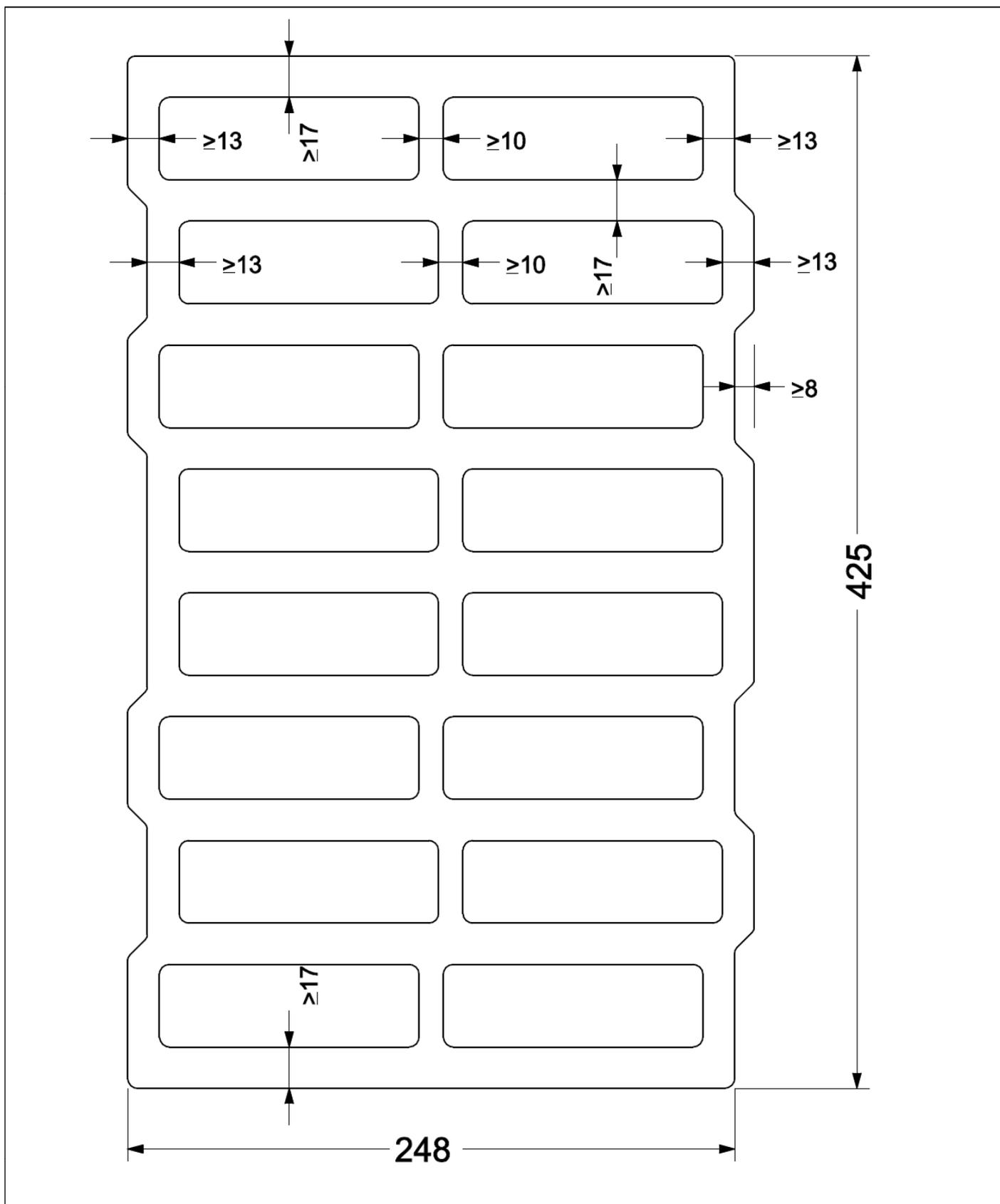
Mauerwerk aus POROTON Planhochlochziegeln mit integrierter Wärmedämmung
