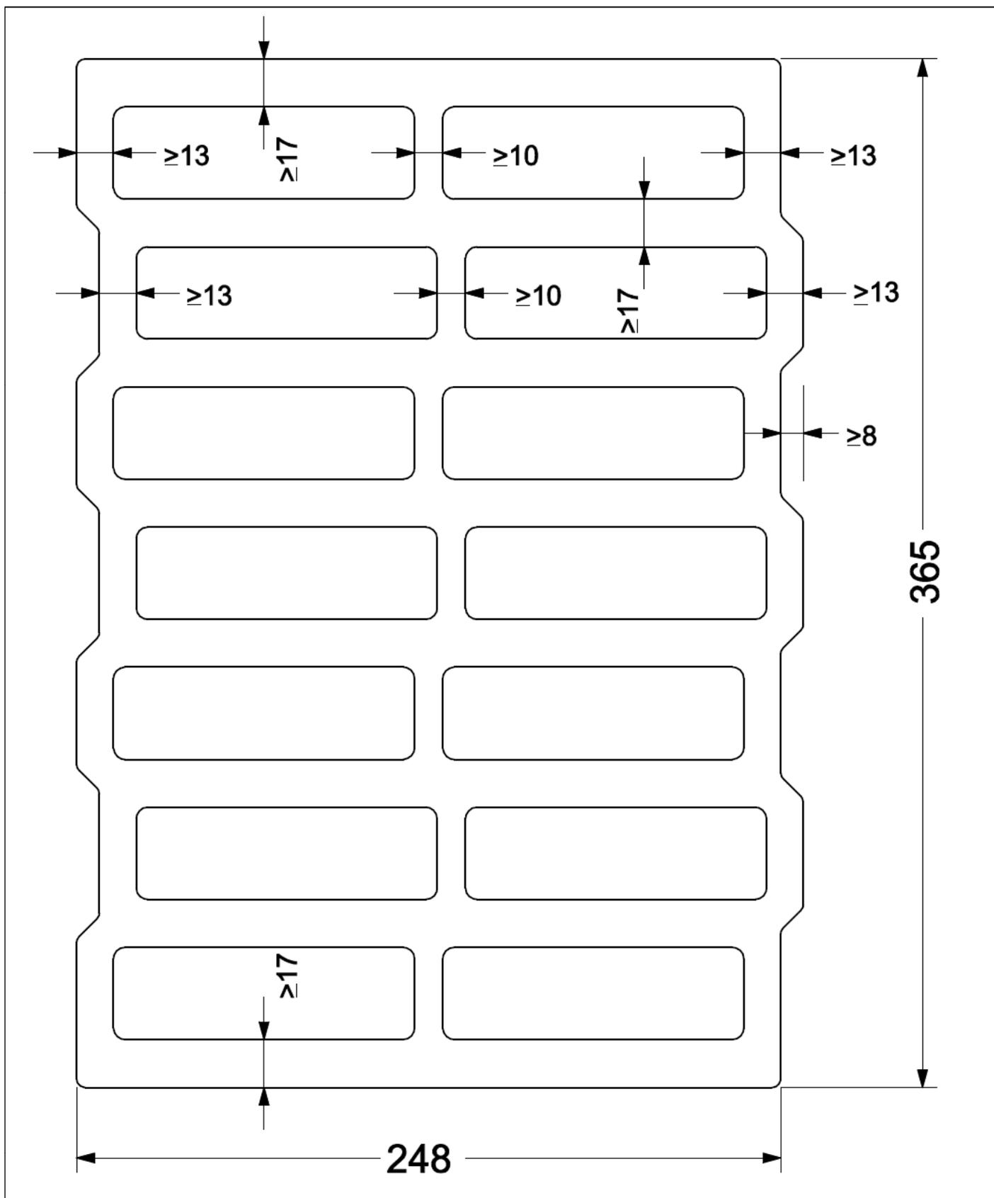
Mauerwerk aus POROTON Planhochlochziegeln mit integrierter Wärmedämmung
