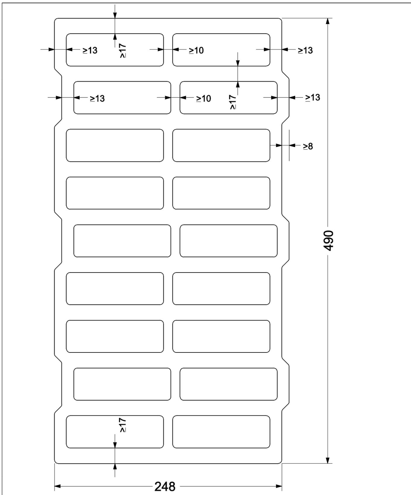
Mauerwerk aus POROTON Planhochlochziegeln mit integrierter Wärmedämmung
