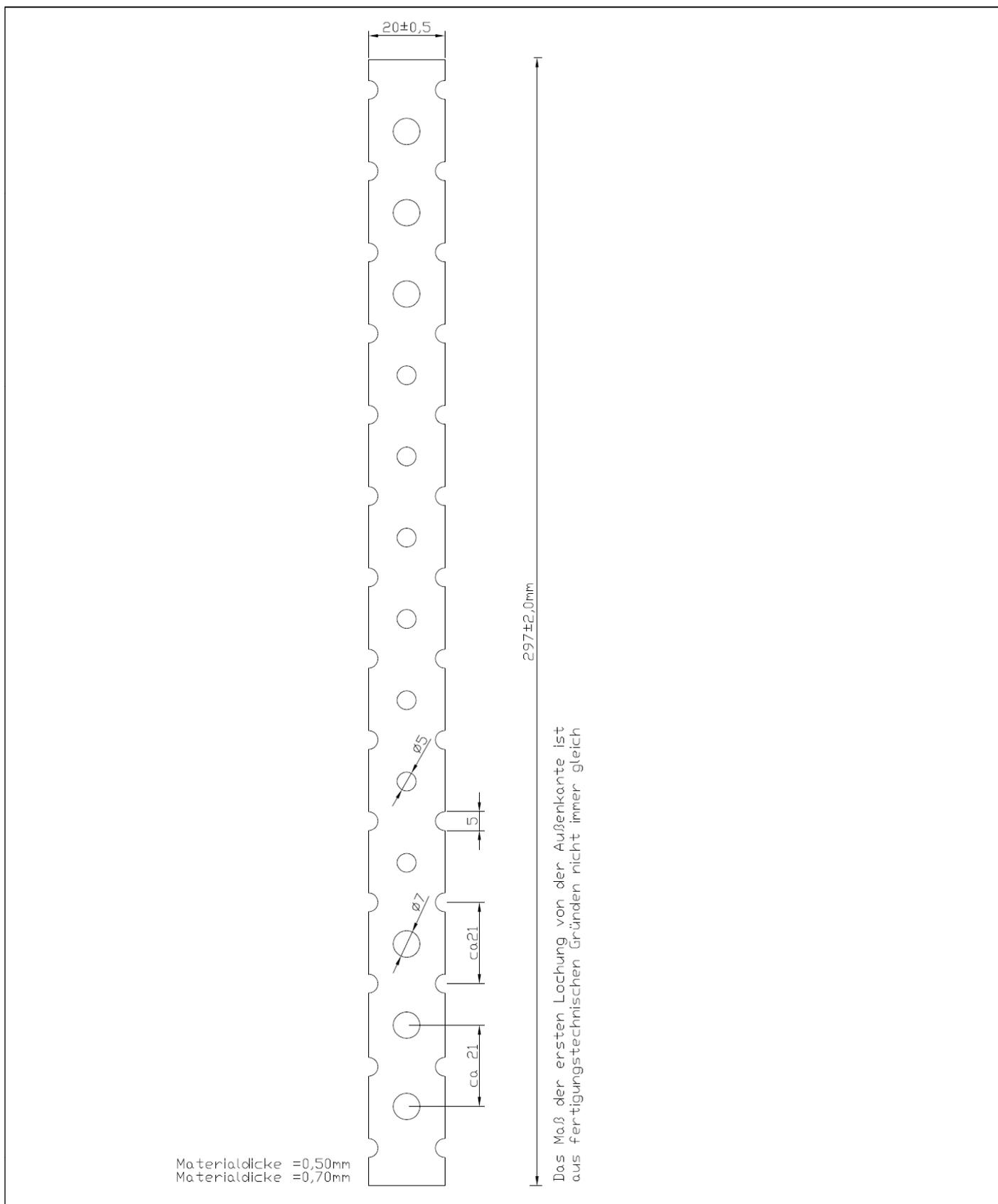
**Mauerverbinder für die Verbindung von Mauerwerkswänden
