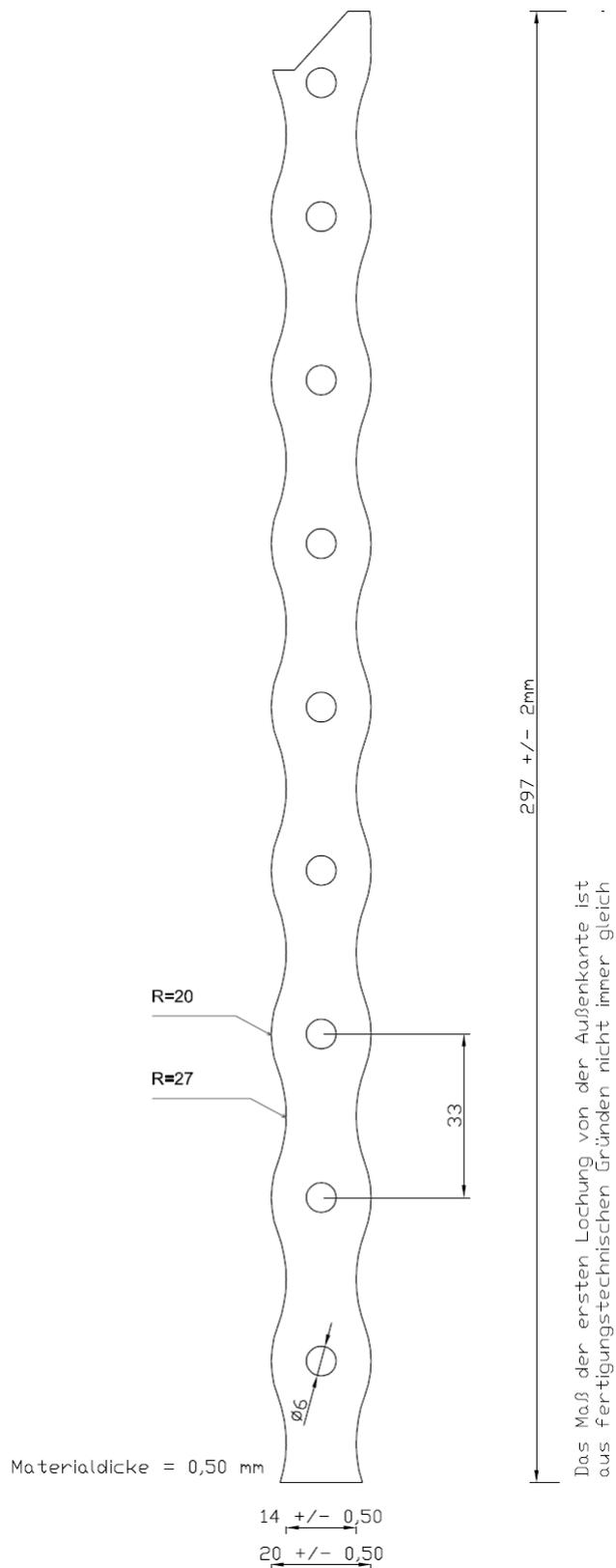
Mauerverbinder für die Verbindung von Mauerwerkswänden
