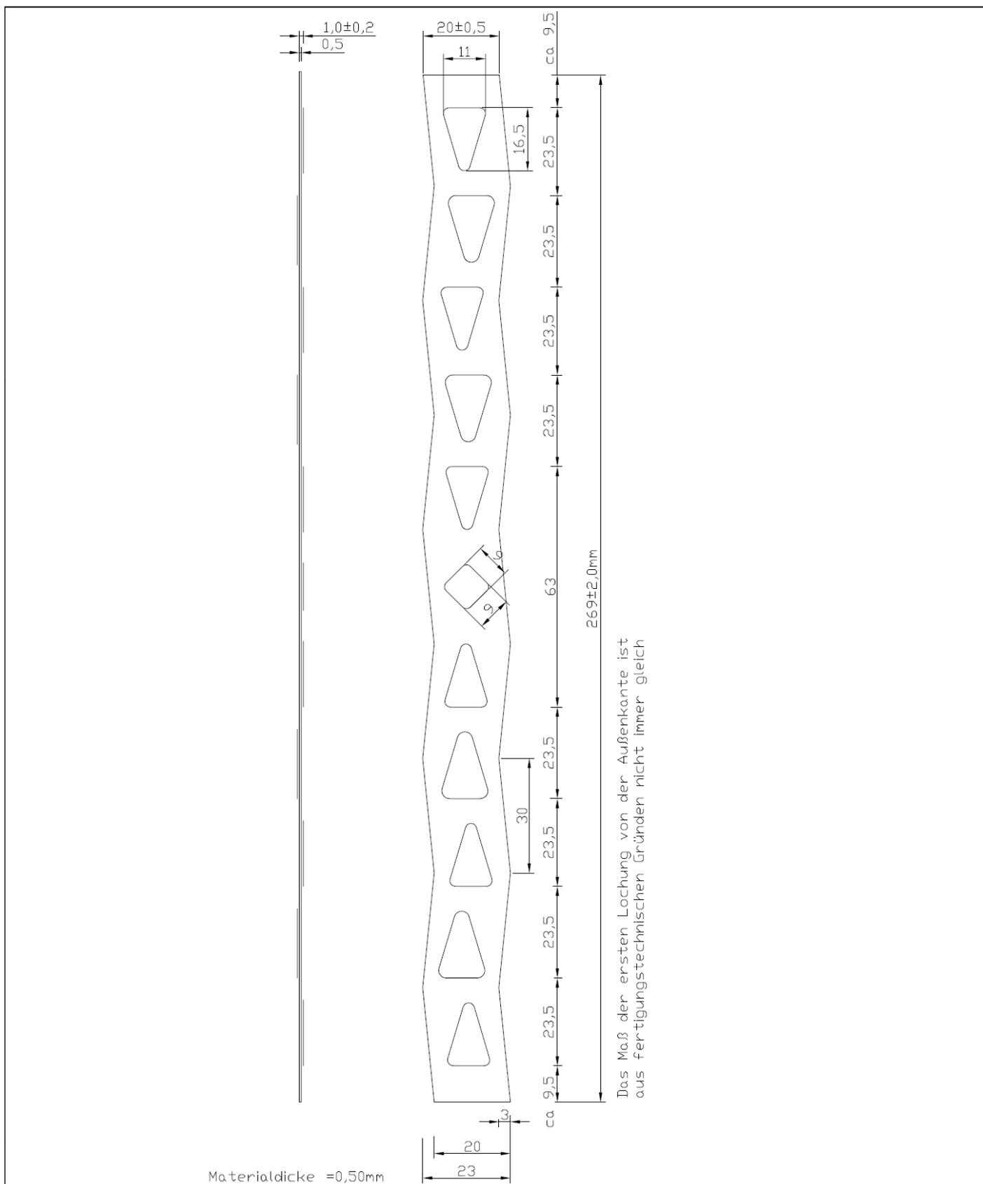
**Mauerverbinder für die Verbindung von Mauerwerkswänden
