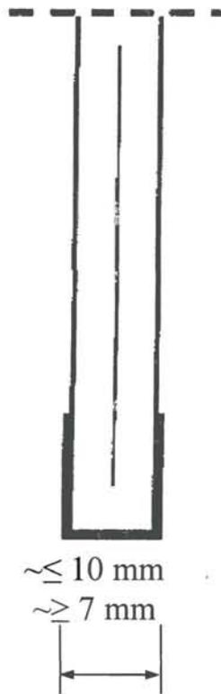
Brandschutz-Verbundglas gemäß DIN EN 14449 bestehend aus Floatglasscheiben mit zwischen liegenden Funktionsschichten.
