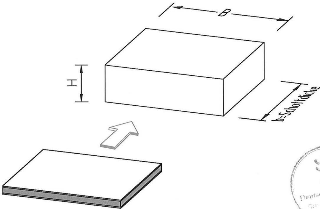
Der ZZ-Vakuumstein 120 BDS-N wird in die Restspalte eingefügt und verschließt diese nach Öffnen der Folie.
