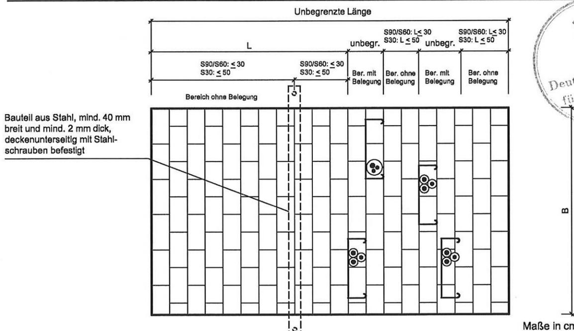
Bei Einbau in Massivdecken muss in Abschottungen ohne Belegung bzw. in Bereichen ohne Belegung mit einer Länge  $L > 50$  cm bzw.  $L > 30$  cm eine der folgenden Maßnahmen erfolgen:
