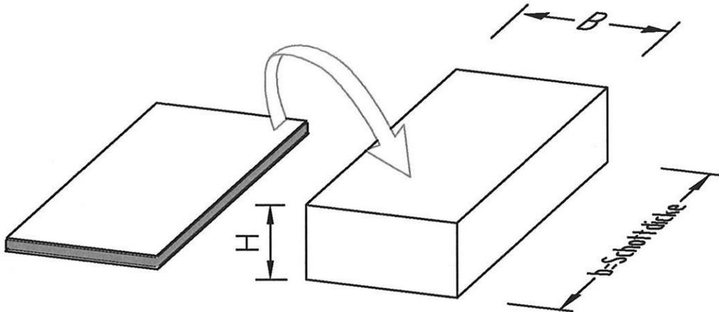
Der ZZ-Vakuumstein 170 BDS-N wird in die Restspalte eingefügt und verschließt diese nach Öffnen der Folie. Wahlweise darf der ZZ-Vakuumstein 170 BDS-N mit oder ohne Folie eingebaut werden.
