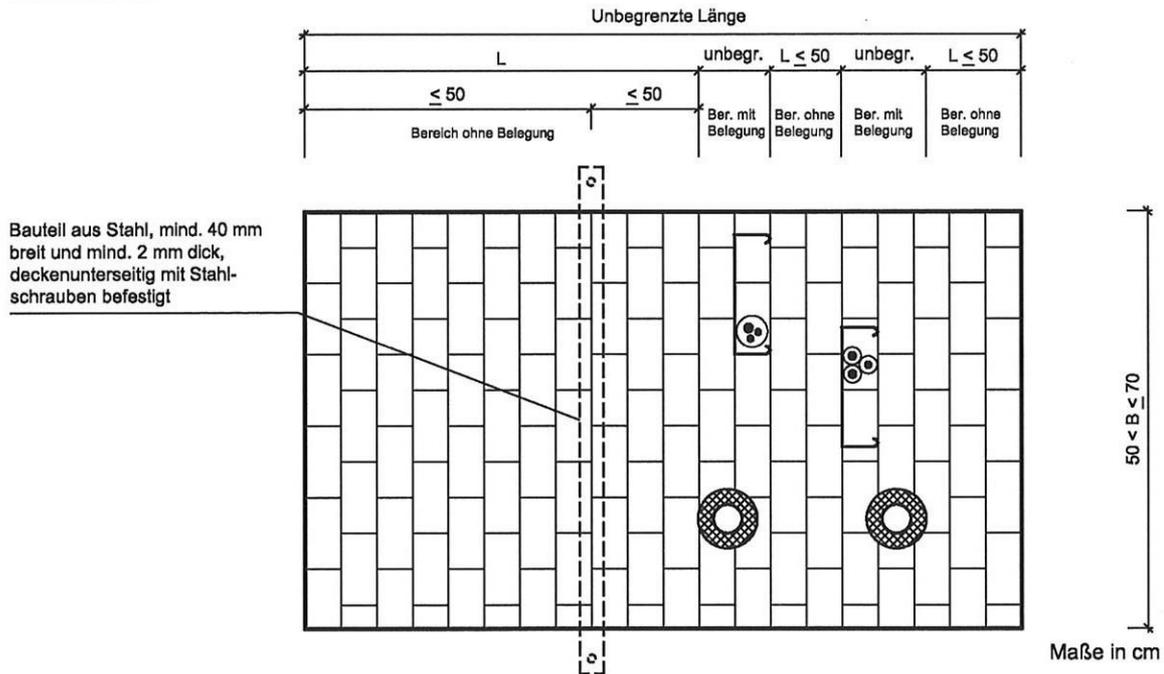
Bei Einbau in Öffnungen in F90-Massivdecken (s. Anlagen 9 und 10), die breiter als  $50 \text{ cm} < B \leq 70 \text{ cm}$  sind, muss in S90-Abschottungen ohne Belegung bzw. in Bereichen ohne Belegung mit einer Länge  $L > 50 \text{ cm}$  eine der folgenden Maßnahmen erfolgen:
