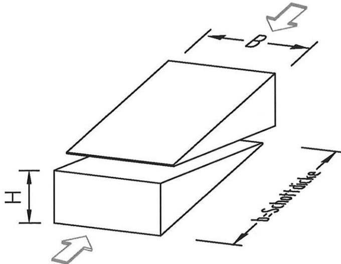
Der Nachinstallationskeil vereinfacht in schwierigen Einbaulagen das nachträgliche Öffnen der Kabelabschottung. Die mit den Nachinstallationskeilen belegte Schottfläche darf eine Größe von 30 cm x 15 cm (B x H) nicht überschreiten.
