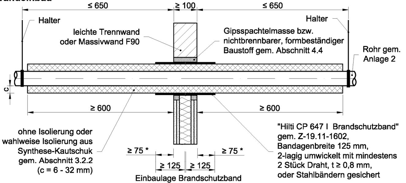
\* bei Einbau in Massivwänden mit einer Dicke von  $\geq 150$  mm darf der Überstand auf 50 mm reduziert werden
