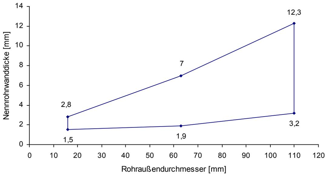
Rohre gemäß Rohrgruppe B der Anlage 1
