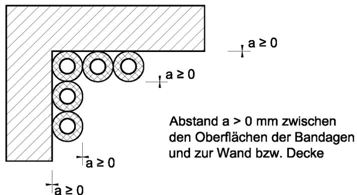
Der Abstand zwischen Rohrabschottungen an nicht isolierten Rohren muss  $a \geq 10$  cm betragen
